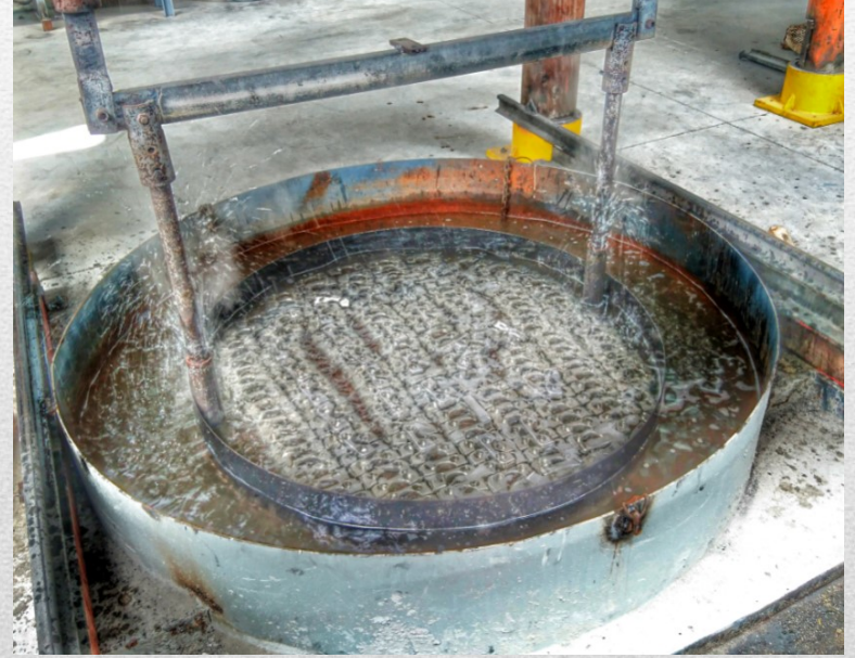
Su verme işlemi. Isıl işlem sepetinin su tankına giriş anı.
