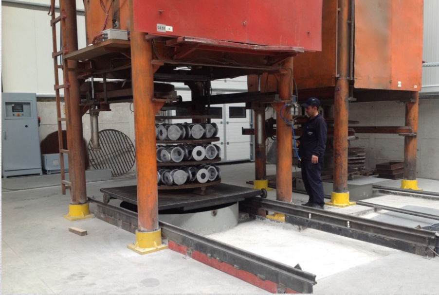
Parçaların ısıtma fırınına yüklenmesi
